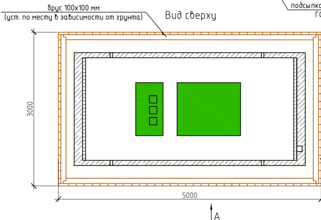
1,2-варианты входа стоков (ввод трубы монтируется при ш/м, либо по желанию заказчика, в соответствии с размерами указанными на данной монтажной схеме на заводе изготовителя)
